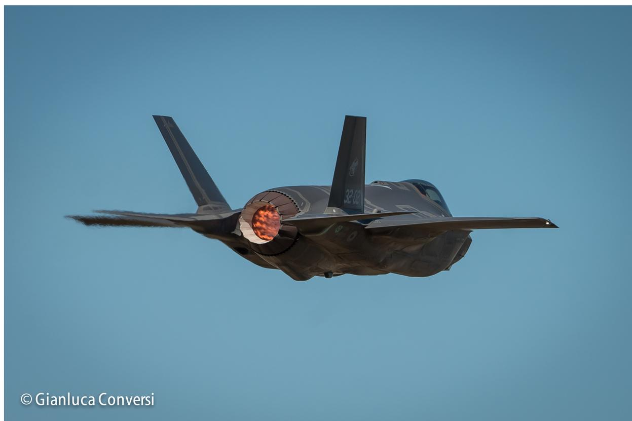
lo scarico è naturalmente schermato tra i due piani di coda orizzontali e dalle due derive verticali orientate verso l'esterno, di disegno non particolarmente avanzato, se confrontate con le analoghe montate sul F-22.
